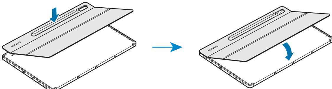
**3** Poravnajte priključke na tabličnem računalniku in tipkovnici, nato pa tipkovnico pritrdite na tablični računalnik.
