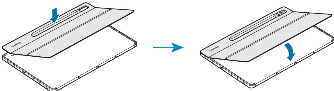
**3** Aliniați conectorii tabletei și tastatura, iar apoi conectați tastatura la tabletă.
