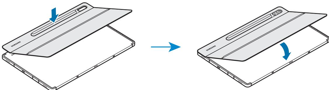
3 对准平板电脑和键盘的连接器，然后将键盘附接至平板电脑。
